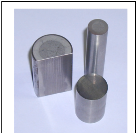
\phi 0.1(\text{mm}) \sim \phi 0.4(\text{mm}) の細孔を約800流路構成 = \phi 2.8(\text{mm}) \sim \phi 11.3(\text{mm}) の単孔と等価流路断面
